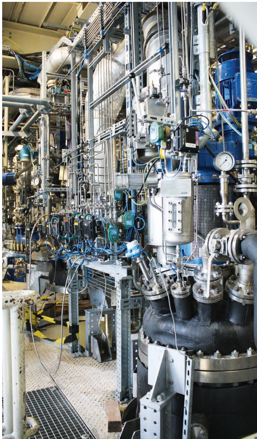
Kautschuksynthese im Pilotmaßstab (600 L Reaktor).
